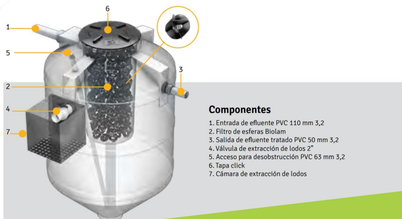
Figura 1: Componentes de un Biodigestor. Manual del Biodigestor Autolimpiable Rotoplas. Pag. 5. www.rotoplas.com.ar
