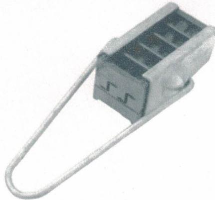
**Morseto Fase con Fusible de 35 A.** Doble función (conexión y protección de fase). Con un bulón con cabeza fusible y grasa en las zonas de contacto. Normalizado.
