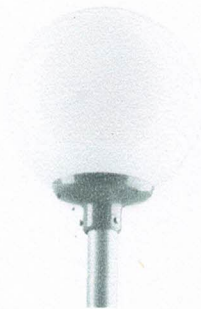
2.13. Lámparas LED de 80 W color blanco: 220Vca 50Hz. E40, uso vertical. Diseño magnolia. Características mínimas; 6400k, 5000 lúmenes y 20.000hs de vida útil.
